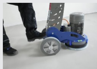
S podnožkou pro snadné naklápění stroje
