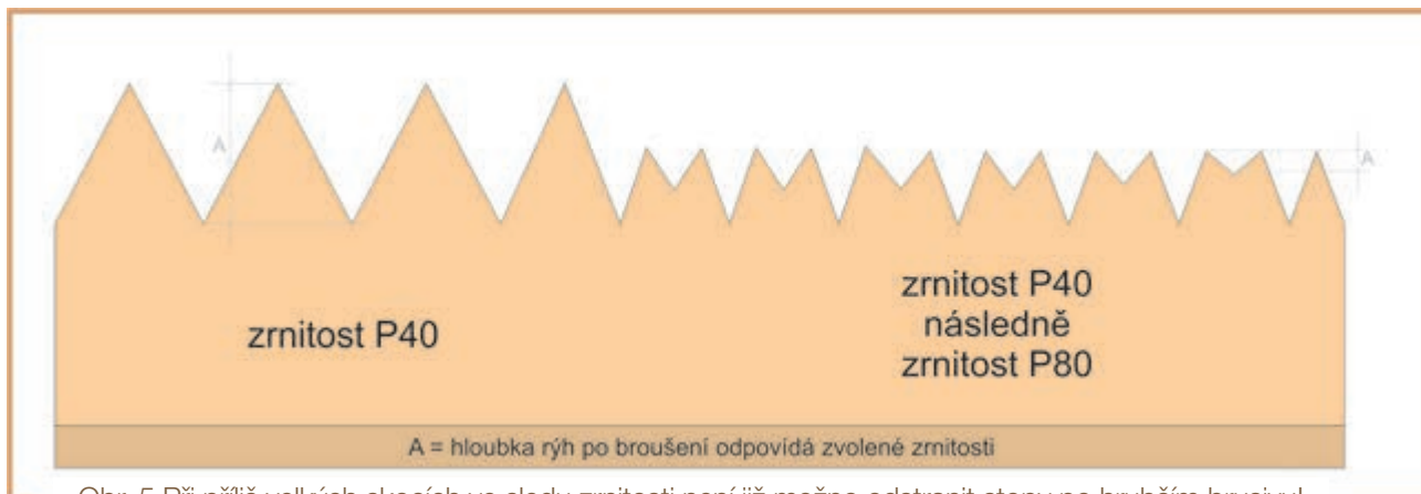
Obr. 5 Při příliš velkých skocích ve sledu zrnitosti není již možno odstranit stopy po hrubším brusivu!
